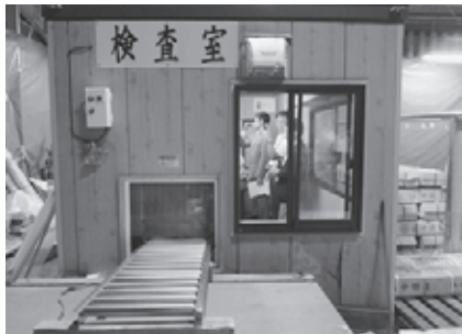
昆布を一駄ずつ通し異物混入を検査するX線装置
