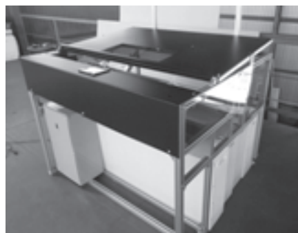
昆布を重量で選別する重量選別機。1時間で2000枚を処理できるそう
