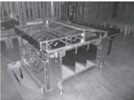
重量基準で選別を行う選別機。組合が購入し、漁業者がリリースで利用しているところも
