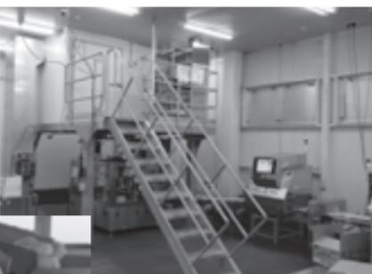
品質を保つため「自動計量包装機」の本体である階段の上部分は丸ごと冷蔵庫内に入っています
