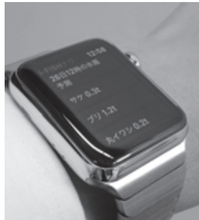
定置網に設置した魚群探知機のデータを利用し、どのような魚種がどの程度入っているかを予測し、スマートウォッチに送信してくれる（画像提供：公立はこだて未来大学）
