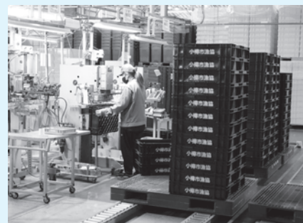
製造されたトロ函一つ一つにラベルを印刷
