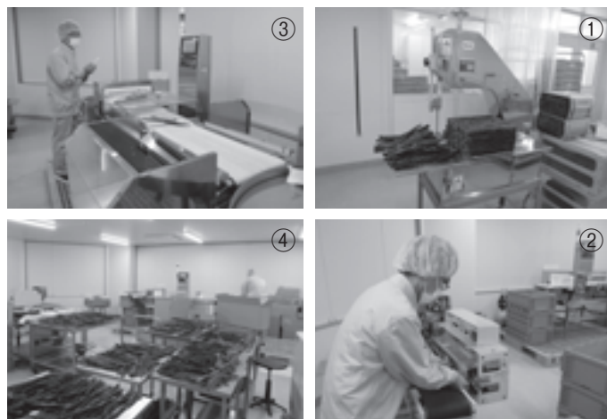
大阪本社の製品加工室。①昆布を規定の長さに切断するバンドソー、②袋詰めした商品を密封するシール印字機、③重量チェッカー機能付き金属探知機、④加工室の全景。撮影当日は納品された原藻昆布を広げて異物がないか確認していました
