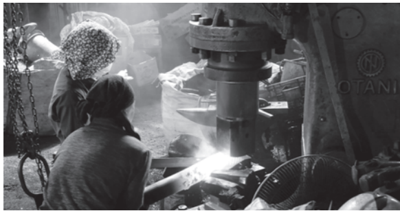
高温の炉で熱した鉄柱を長年の経験と技術で鍛造し、アンカーを製造しています
